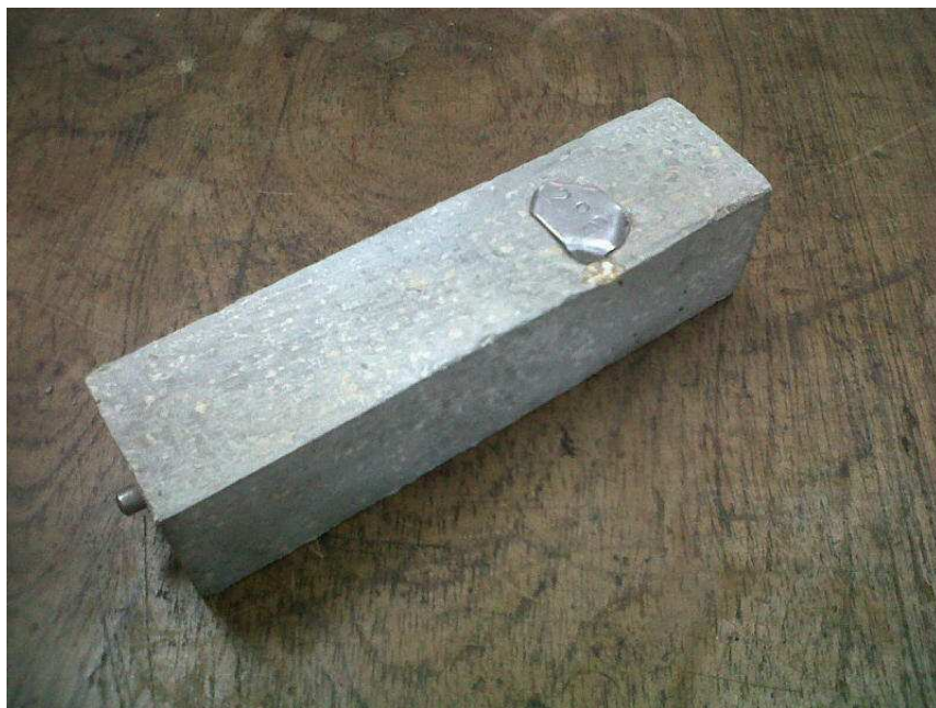
Figura 2.6 Aspecto de las barras de mortero (40 mm x 40 mm x 160 mm) del método RILEM AAR-2
