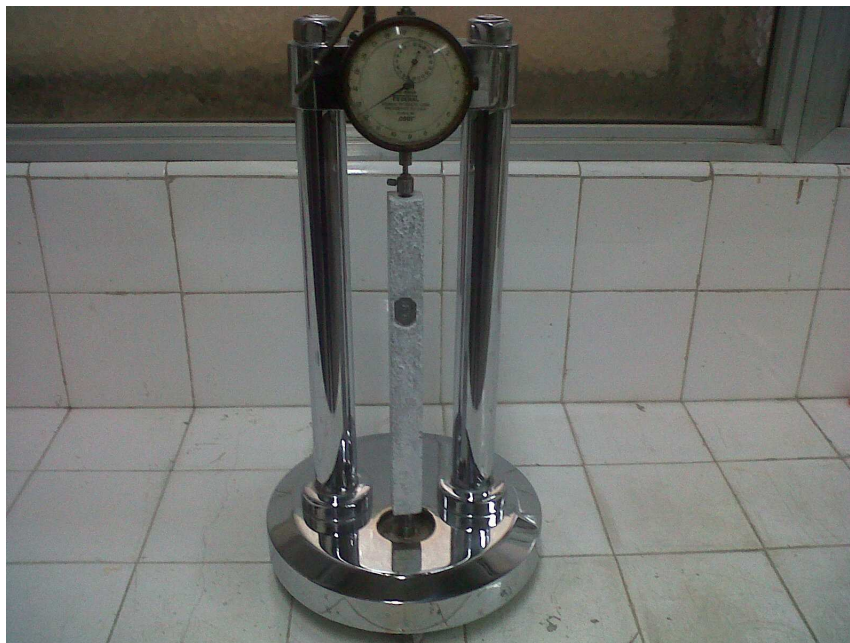
Figura 2.5 Comparador analógico de base fija (precisión 0,0001")
