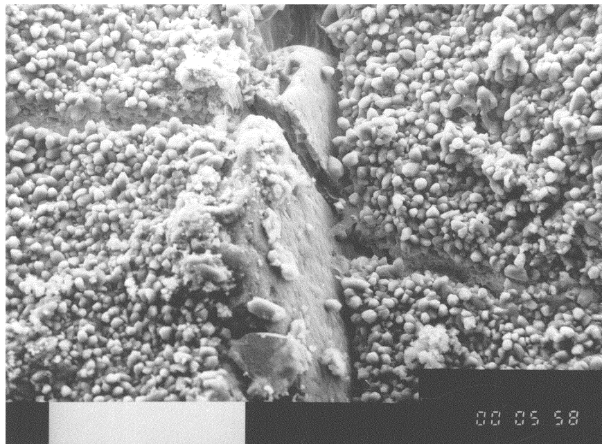
Figura 3.15 Aspecto del testigo M9-2 luego del ataque alcalino (x 4000, escala 50 \mu\text{m} )
