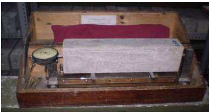
Figura 2.7 Comparador de longitud analógico (precisión 0,0001”)
