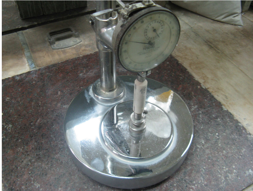
Figura 2.4 Comparador analógico de base ajustable (precisión 0,0001")
