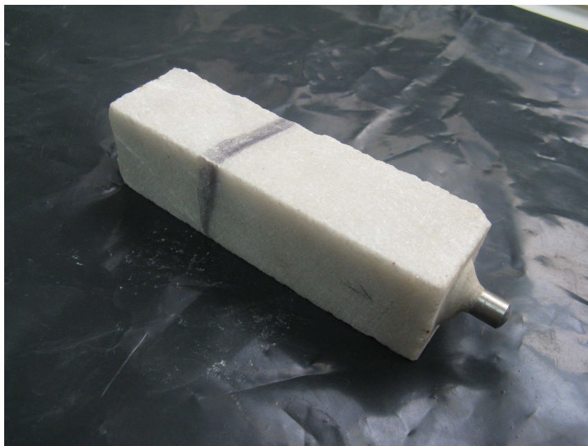
Figura 2.3 Aspecto de los testigos prismáticos de roca (25 mm x 25 mm x 70 mm)
