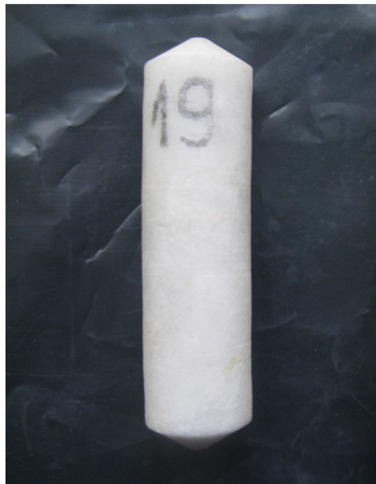
Figura 2.2 Aspecto de los testigos de roca cilíndricos (19 mm x 75 mm)
